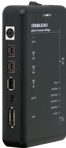
Slika 6. Bloker, kompanije "Tableau", pomoću koga se vrši blokada kompjutera i pravljenje "imidža" kao dokaznog sredstva.
